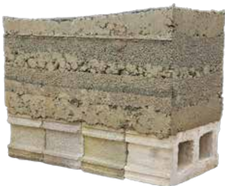
Resultado final del prototipo. Asiento de dunita apisonada. Foto cedida por el autor.
