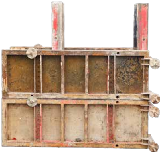
Encofrado por etapas para facilitar el apisonado. Foto cedida por el autor.
